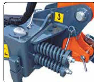
Ammortizzatore meccanico. Salvaguardia in caso di ostacolo. Spring shock absorber. Protection in the event of obstacles.
