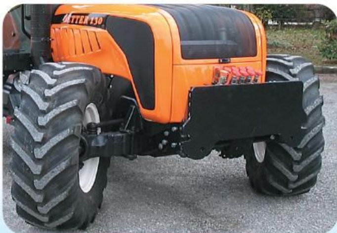
Priekinė jungtis su komunaline plokšte sniego valytuvui-verstuvui.
