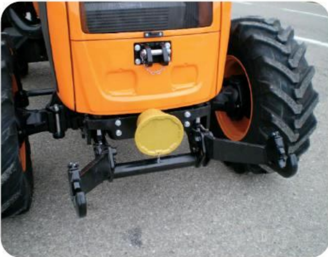
Priekinis GTV ir priekinė pakabinimo sistema su galimybe nuimti šlaunis.
